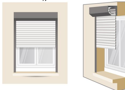
Roleta elewacyjna - montaż na murze
